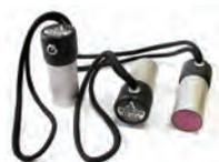
Преобразователями с жидкостным контактом для сквозного прозвучивания:
